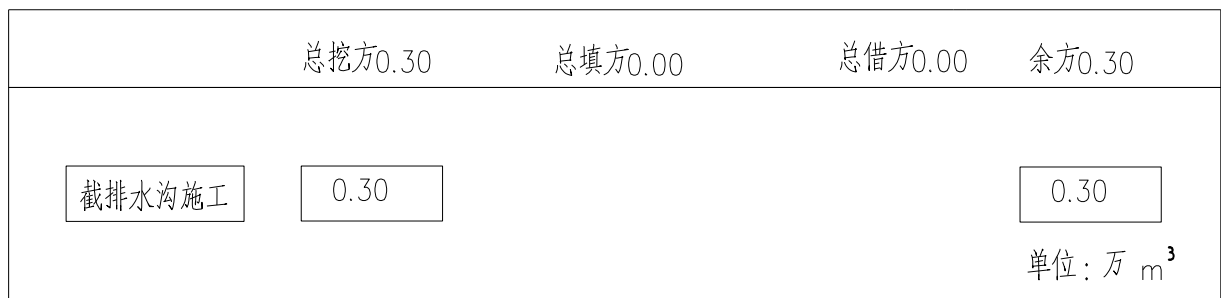
图 2-2 土石方流向框图 单位：万 \text{m}^3
