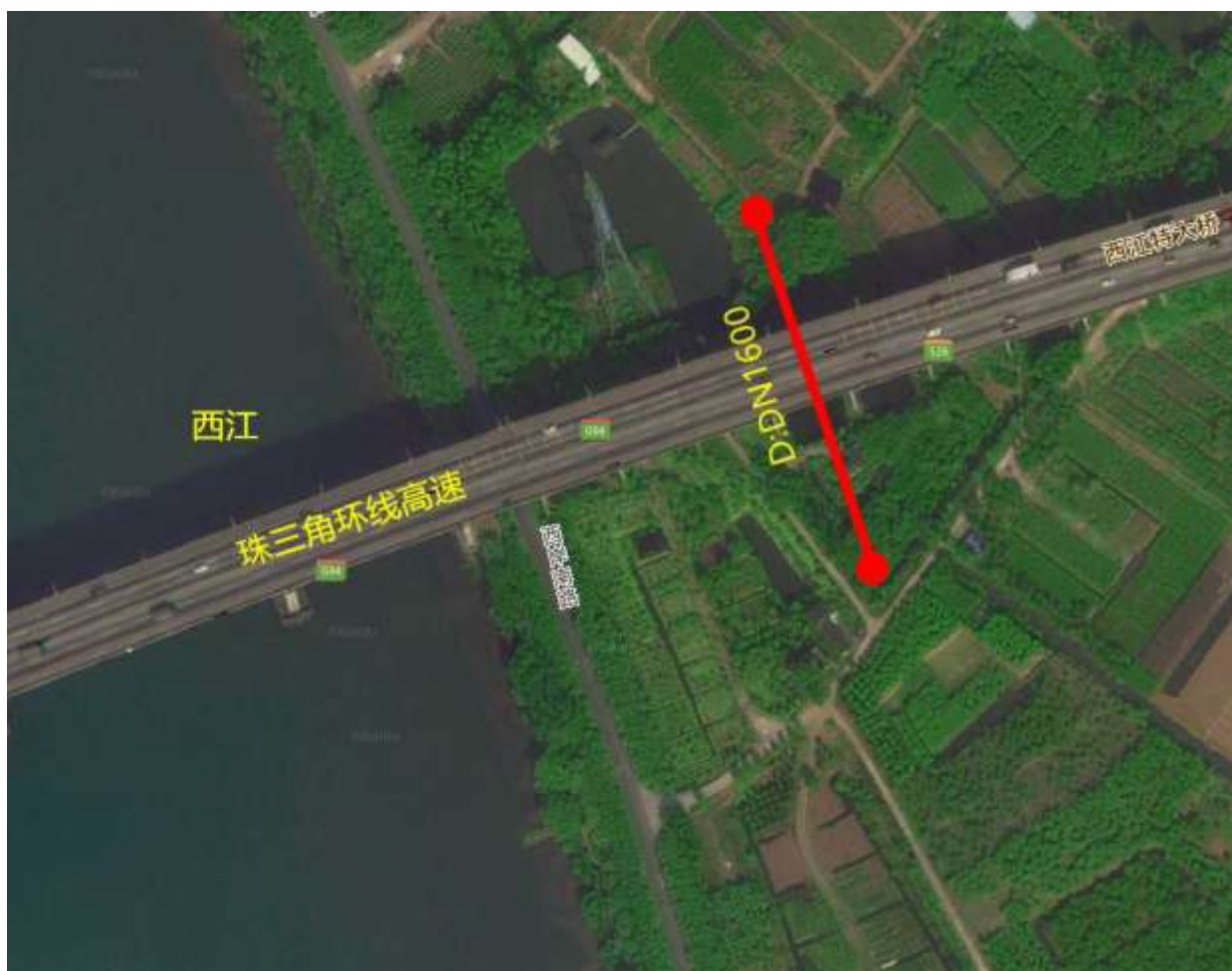
图2-24 顶管穿越珠三角环线高速卫星图
