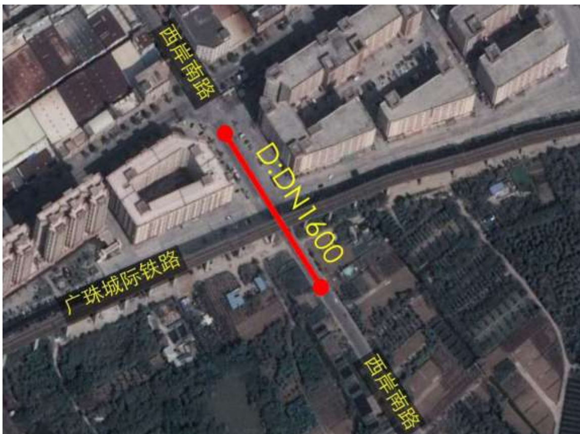
图2-26 横穿广珠城际轻轨顶管施工示意图
