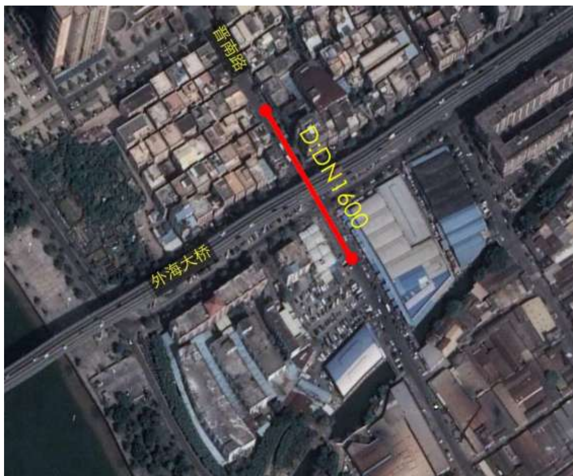
图2-28 顶管穿越外海大桥高架卫星图
