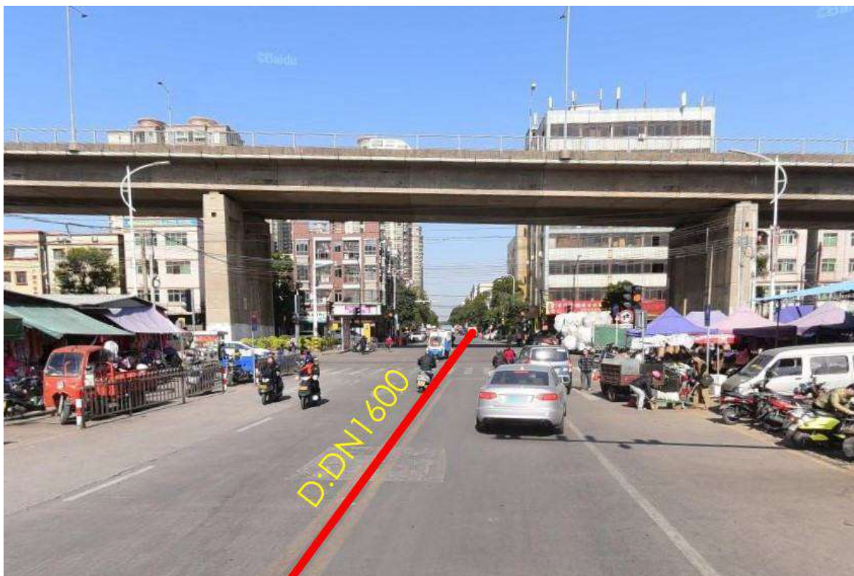
图2-27 顶管穿越外海大桥高架现场示意图
